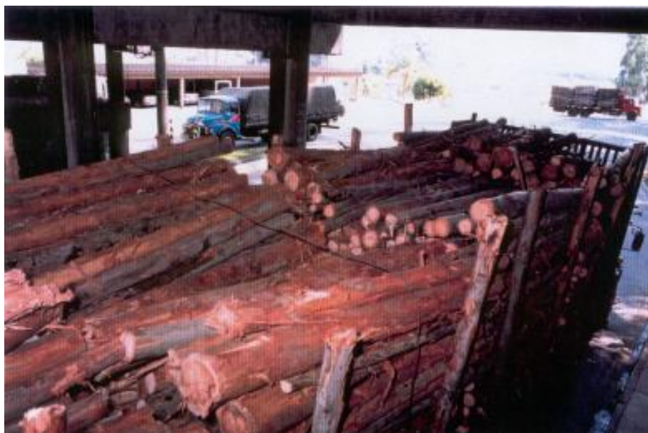
Figura 8: Carga com empilhamento longitudinal com uma “gaiola” em forma de “V”. Propositadamente, as toras foram empilhadas com maior altura nas bordas da carrocera gerando um grande espaço vazio no meio da carga.
