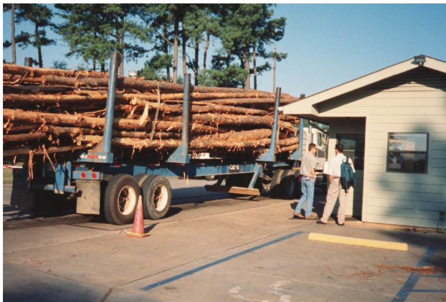
Figura 2: Transporte de madeira colhida pelo sistema de toras longas.
